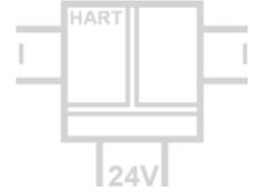
**L'alimentation transmetteur GC 52500 sert à alimenter et à isoler les signaux provenant de transmetteurs 2 et 3 fils SMART et les signaux de capteurs actifs avec liaison HART.**
