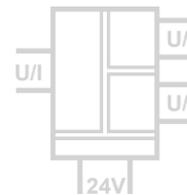
**Le séparateur / répéteur de signaux GN 21000 sert à l'isolement, la conversion et la distribution de signaux standards de 0/4 ... 20 mA, 0/1 ... 5 V et 0/2 ... 10 V. L'appareil peut également alimenter la boucle pour des transmetteurs 2 fils.**
