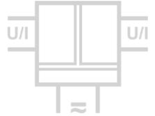
L'amplificateur d'isolement GN 25000 sert à l'isolement et à la conversion de signaux standards de 0/4 ... 20 mA et 0/2 ... 10 V.
