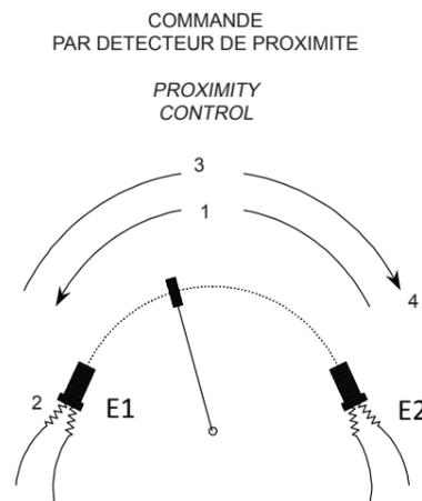
Exemple E1 : Détecteur de vanne ouverte / opened valve detector
